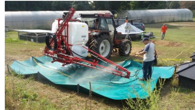
Arete smontabili attrezzate per il lavaggio dell'irroratrice e per il convogliamento delle acque di lavaggio in appositi serbatoi di raccolta/trattamento
